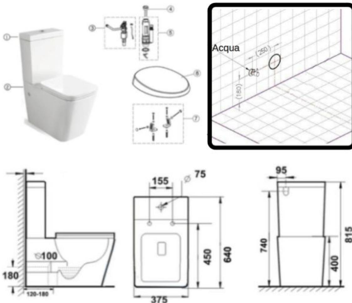
I sanitari WC con Cassetta Esterna Minimal hanno la possibilità di essere installati sia a parete che a pavimento con l'apposita curva tecnica.
